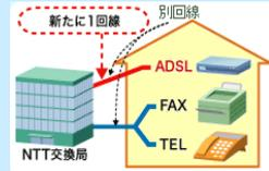
電話回線をご利用でない場合やISDNをご利用でアナログ回線への切り替えが難しい場合に、ADSL専用のアナログ回線を敷設することで、ブロードバンドインターネットをお楽しみいただけるようになります。
