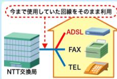
現在ご利用のアナログ電話回線にADSLモデムを接続していただくことで、簡単にブロードバンドインターネットをお楽しみいただけるようになります。(図は接続の一例です。)
